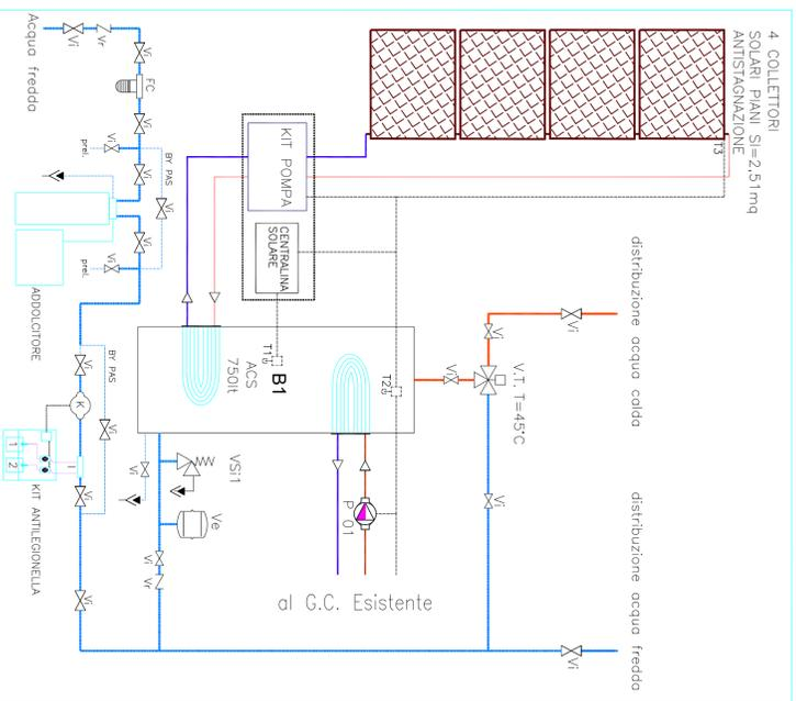
SCHEMA IDRAULICO IMPIANTO A.C.S. BOILER 1 - 750L
