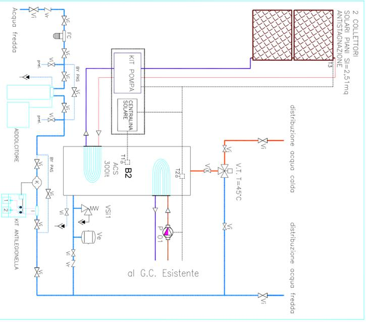
SCHEMA IDRAULICO IMPIANTO A.C.S. BOILER 2 - 300L
