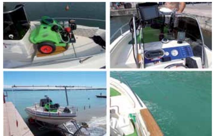
Figura 2 - In alto a sinistra: pompa installata sull'imbarcazione; In alto a destra: dettaglio del Gps differenziale. In basso a sinistra: insieme della barra di trattamento; a destra: dettaglio della barra in immersione
